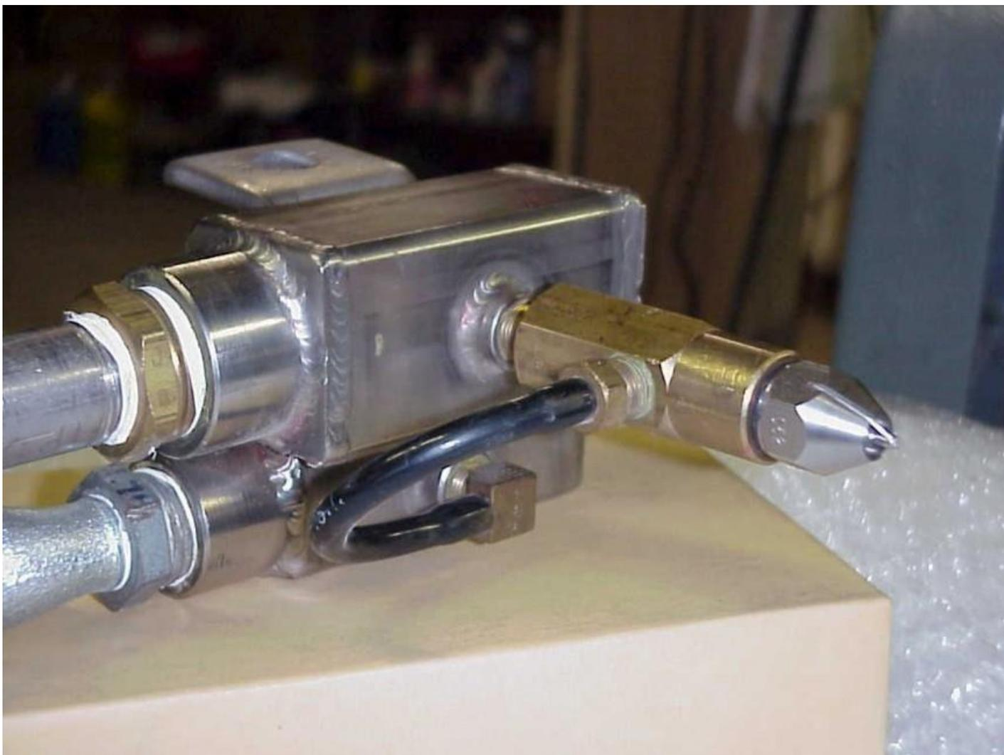
La Figura 7, ilustra las capacidades de Ultra Fine empañamiento de las boquillas utilizadas para aplicaciones de control de polvo fugitivo.
